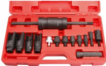
Kugelgelenk ermöglicht den Einsatz des Gleithammers auch bei beengten Platzverhältnissen und damit eine leichte und schnelle Demontage des Injektors
